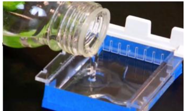
F- Verser de l'agarose liquide
